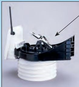
Progettato per rispondere alle direttive della Organizzazione Meteorologica Mondiale, il nostro pluviometro con **bilancino auto-svuotante** placcato in alluminio è resistente alla corrosione ed è tarato al laser per la massima precisione.
